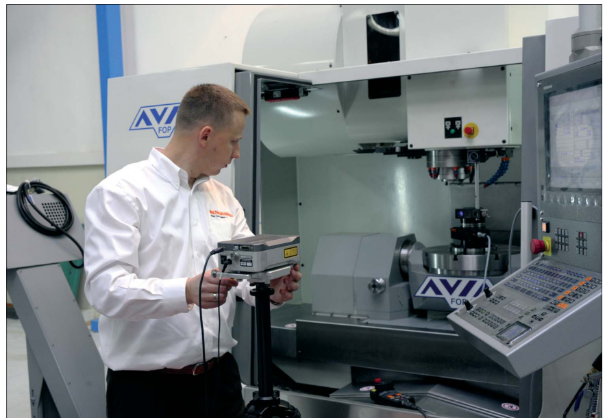
Rys. 4. Ustawianie interferometru laserowego XL80 wraz z przystawką RX10 do pomiaru osi obrotowych na centrum obróbkowym Vario firmy AVIA
