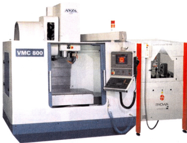
Centrum AVIA VMC 800 z automatyzacją EROWA EasyChange 10 palet ITS (do 40 kg na palecie)
