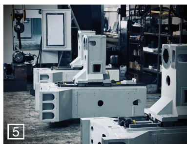
2 – Wrzeciono 15 000 obr/min. 5 – Masywne komponenty żeliwne.
