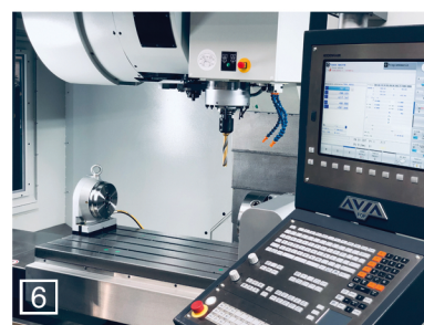
3 – Duża przestrzeń robocza. 6 – Sterowanie CNC Heidenhain.
